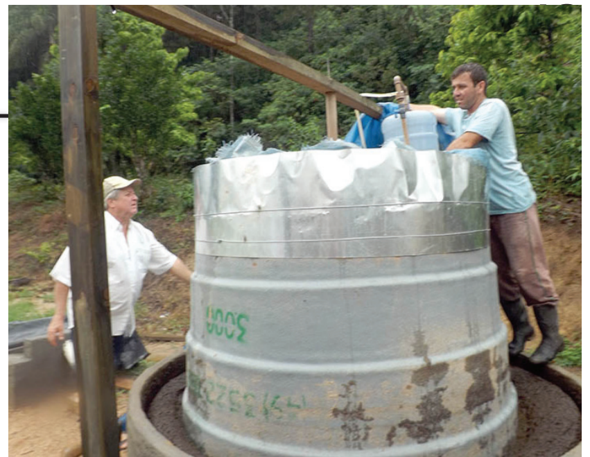
Wagner e Seu Antônio “alimentam” o biodigestor com um balde de 20 litros de esterco duas a três vezes por semana.
