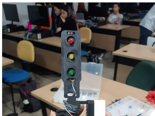
Figura 2.2: Semáforo de trânsito impresso em 3D montado
